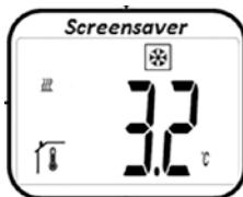
Med udgangspunkt i visningen vises indstillet frostbeskyttelsestemperatur (blinker) ved at trykke på eller tasterne. Ved yderligere tryk på eller tasterne kan den ønskede frostbeskyttelsestemperatur indstilles. Ved tryk på tasten bekræftes den ønskede frostbeskyttelsestemperatur.
