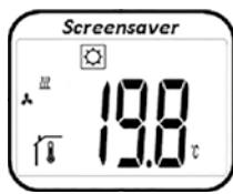
Ausgehend von der Anzeige erscheint durch Drücken der oder Tasten die eingestellte Soll- Temperatur (blinkend). Durch weiteres Drücken der oder Tasten kann die gewünschte Solltemperatur eingestellt werden. Durch Drücken der Taste wird die gewünschte Soll- Temperatur bestätigt.
