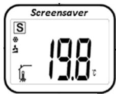
Uitgaande van het display verschijnt door te drukken op de of toetsen het ingestelde snelheidsniveau (knippert). Door verder te drukken op de of toetsen kan het gewenste snelheidsniveau ingesteld worden. Door te drukken op de toets wordt het gewenste snelheidsniveau bevestigd.
