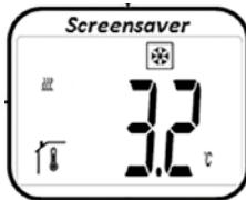
Ausgehend von der Anzeige erscheint durch Drücken der oder Tasten die eingestellte Frostschutztemperatur (blinkend). Durch weiteres Drücken der oder Tasten kann die gewünschte Frostschutztemperatur eingestellt werden. Durch Drücken der Taste wird die gewünschte Frostschutztemperatur bestätigt.
