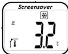
En partant de l'affichage donné, appuyer sur  $-$  ou  $+$  pour afficher la température anti-gel de consigne préréglée (clignotant). Appuyer encore une fois sur  $-$  ou  $+$  pour régler la température anti-gel voulue.
