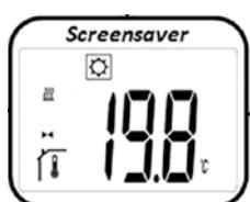
Näytöstä lähtien painamalla painikkeita  $-$  tai  $+$  asetettu lämpötila ilmestyy (vilkku-en). Painamalla uudestaan  $-$  tai  $+$  voidaan asettaa haluttu lämpötila. Painamalla  $OK$ -painiketta haluttu asetus-lämpötila vahvistetaan.
