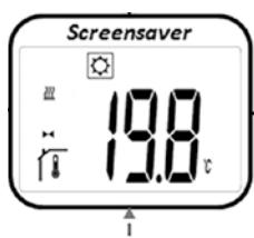
Uitgaande van het display verschijnt door te drukken op de of toetsen de ingestelde gewenste temperatuur (knippert). Door verder te drukken op de of toetsen kan de gewenste temperatuur ingesteld worden. Door te drukken op de toets wordt de gewenste temperatuur bevestigd.
