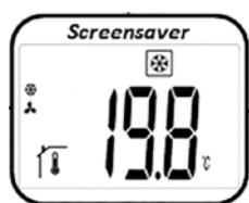
Näytöstä lähtien painamalla painikkeita tai asetettu lämpötila ilmestyy (vilkkuen). Painamalla uudestaan tai voidaan asettaa haluttu lämpötila. Painamalla -painiketta haluttu asetuslämpötila vahvistetaan.
