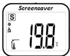
Näytöstä lähtien painamalla painikkeita  $-$  tai  $+$  asetettu lämpötila ilmestyy (vilkku-en). Painamalla uudestaan  $-$  tai  $+$  voidaan asettaa haluttu kierroslukutaso. Painamalla  $OK$ -painiketta haluttu kierroslukutaso vahvistetaan.
