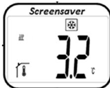
Från den här displayen kommer man genom att trycka på knappen eller till den inställda frostskyddstemperaturen (blinkar). Genom att fortsätta att trycka på knappen eller kan den önskade frostskyddstemperaturen ställas in. Genom att trycka på knappen bekräftas den önskade frostskyddstemperaturen.
