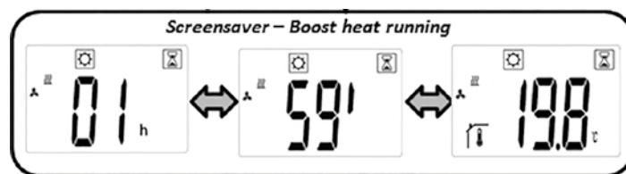
a) Come impostare la temperatura desiderata: dalla schermata iniziale (vedi figura), premere il tasto o per visualizzare la temperatura impostata (lampeggiante). Premere una seconda volta il tasto o per impostare la temperatura desiderata.
