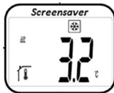
Uitgaande van het display verschijnt door te drukken op de **-** of **+** toetsen de ingestelde vorstbeschermingstemperatuur (knippert). Door verder te drukken op de **-** of **+** toetsen kan de gewenste vorstbeschermingstemperatuur ingesteld worden. Door te drukken op de **OK Mode** toets wordt de gewenste vorstbeschermingstemperatuur bevestigd.
