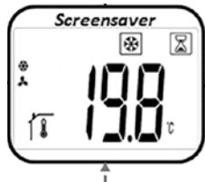
Näytöstä lähtien painamalla painikkeita tai asetettu lämpötila ilmestyy (vilkkuen). Painamalla uudestaan tai voidaan asettaa haluttu lämpötila. Painamalla -painiketta haluttu asetuslämpötila vahvistetaan.
