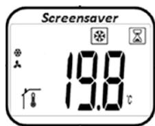
Uitgaande van het display verschijnt door te drukken op de of toetsen de ingestelde gewenste temperatuur (knippert). Door verder te drukken op de of toetsen kan de gewenste temperatuur ingesteld worden. Door te drukken op de toets wordt de gewenste temperatuur bevestigd.
