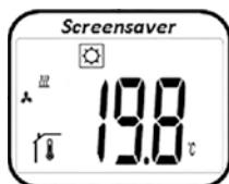
Näytöstä lähtien painamalla painikkeita  $\leftarrow$  tai  $\rightarrow$  asetettu lämpötila ilmestyy (vilkkuu). Painamalla uudestaan  $\leftarrow$  tai  $\rightarrow$  voidaan asettaa haluttu lämpötila. Painamalla  $\leftarrow$ -painiketta haluttu asetuslämpötila vahvistetaan.
