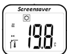
Ausgehend von der Anzeige erscheint durch Drücken der  $-$  oder  $+$  Tasten die eingestellte Soll- Temperatur (blinkend). Durch weiteres Drücken der  $-$  oder  $+$  Tasten kann die gewünschte Solltemperatur eingestellt werden. Durch Drücken der  $OK$  Taste wird die gewünschte Solltemperatur bestätigt.
