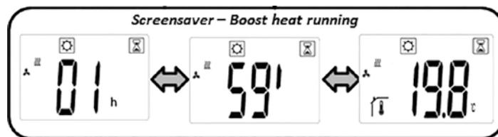
a) Instellen van de gewenste temperatuur: Uitgaande van het display verschijnt door te drukken op de  $-$  of  $+$  toetsen de ingestelde gewenste temperatuur (knippert). Door verder te drukken op de  $-$  of  $+$  toetsen kan de gewenste temperatuur ingesteld worden. Door te drukken op de  $OK$  toets wordt de gewenste temperatuur bevestigd.
