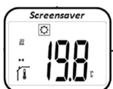
Näytöstä lähtien painamalla painikkeita tai asetettu lämpötila ilmestyy (vilkku-en). Painamalla uudestaan tai voidaan asettaa haluttu lämpötila. Painamalla -painiketta haluttu asetus-lämpötila vahvistetaan.
