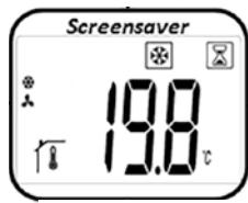
Dalla schermata iniziale (vedi figura), premere il tasto o per visualizzare la temperatura impostata (lampeggiante). Premere una seconda volta il tasto o per impostare la temperatura desiderata. Premere il tasto per confermare. Dalla schermata iniziale (vedi figura) premere due volte il tasto per passare al programma successivo (5.5)
