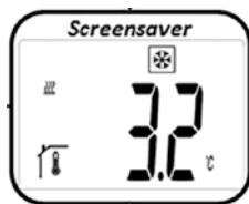
Näytöstä lähtien painamalla painikkeita  $-$  tai  $+$  asetettu jäätymisen estolämpötila ilmestyy (vilkkuen). Painamalla uudes-taan  $-$  tai  $+$  voidaan asettaa haluttu jäätymisen estolämpötila. Painamalla  $OK$ -painiketta haluttu jäätymisen estolämpötila vahvistetaan.
