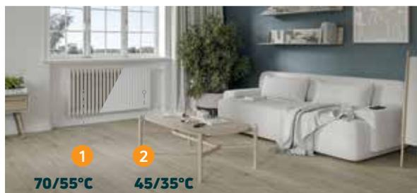
1 Avant la rénovation : Le radiateur fonctionne avec une température de flux de 70°C, par exemple. 2 Après avoir remplacé la chaudière par une pompe à chaleur hautement efficace, la température de flux est considérablement plus basse, par exemple 45°C. Le radiateur à pompe à chaleur Ulow-E assure une température ambiante agréable grâce à son support ventilé.
