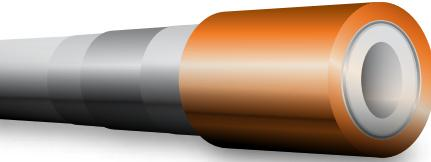
Tube PE à haute densité, réticulée par un processus d'exposition à un faisceau d'électrons, composée de 5 couches dont la barrière anti-diffusion d'oxygène occupe une place centrale. Répond aux normes DIN 4726/ DIN EN ISO 21003.
