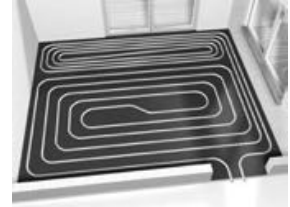
zone périphérique / un seul circuit en spirale assemblée
