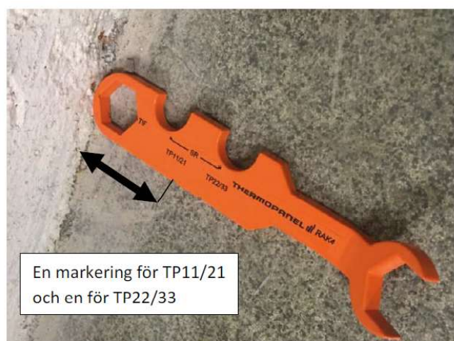
Positionering av SR avstängningar vid åtdragning
