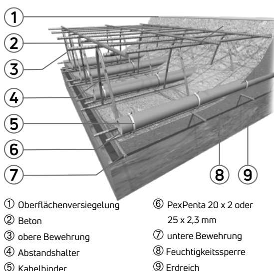
Abb. 86 Systemaufbau Industrieflächenheizung
