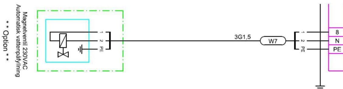
FIGUR 2 VISAR EN ÖVERBLICK AV AUTOMATISKA PÅFYLLNINGSSYSTEMET.
