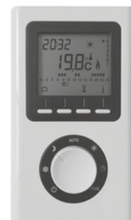
Abb. 32 Der FCIR-Infrarotraumthermostat ist im Lieferumfang inbegriffen. Er ermöglicht die Einstellung der Raumtemperatur im Bereich von 10 °C bis 30 °C mit einer Schrittweite von 0,5 °C. Das Gerät zeigt die aktuelle und eingestellte Temperatur sowie die aktuelle Uhrzeit an. Wandmontage oder Tischaufstellung sowie Wochenprogrammerstellung und Timerfunktion (15 Minuten bis 4 Stunden) sind möglich. Stromversorgung über 2x LR03 (AAA) Batterien
