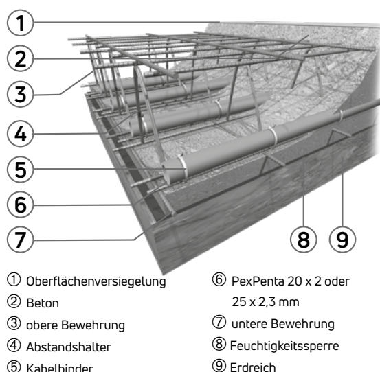
Abb. 86 Systemaufbau Industrieflächenheizung
