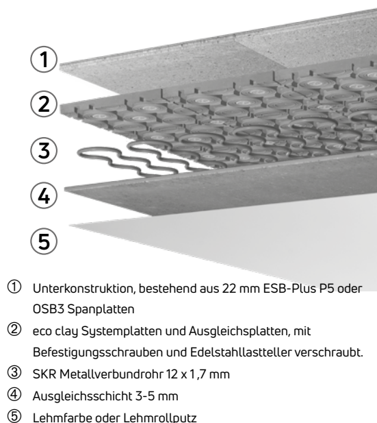
Abb. 72 LehmSystem eco clay – Systemaufbau
