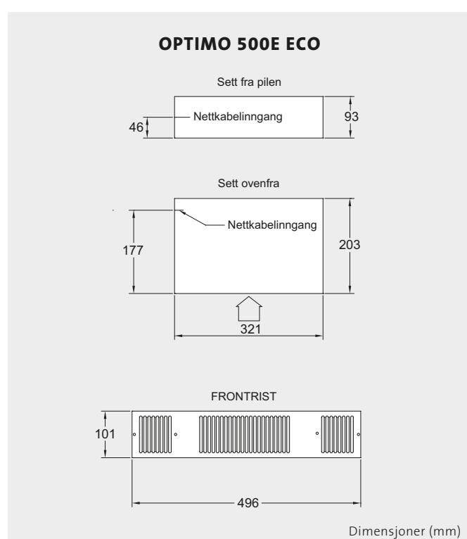
**NB:** Legg til 4,5 mm til kabinetthøyden for å gi rom til gummibeslag og skruer.
