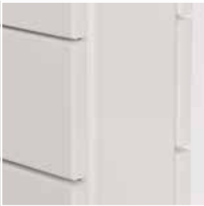
Die waagrecht übereinander und hintereinander angeordneten Flachrohrmodule sind jeweils 70 mm hoch, zwischen den Modulen ist ein Spalt von 2 mm.
