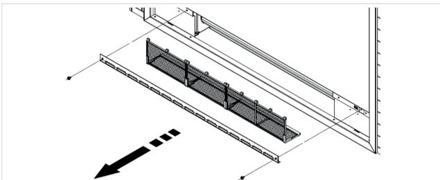
• Replacer les filtres, en veillant tout particulièrement à insérer le bord inférieur (A) dans son logement (B).
