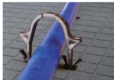
Utilisation d'agrafes sur les Cosydalle planes PANEL PIRSL ou Graphite PSE. Il est recommandé d'appliquer 3 agrafes/m de tube en moyenne.
