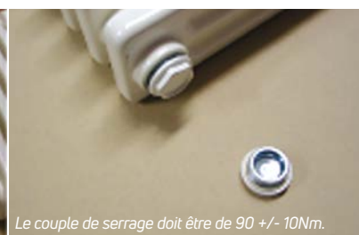
6. Positionnement des bouchons et purgeurs
