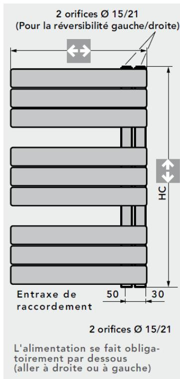
Equipé de 2 orifices en bout ( $\varnothing$  15/21) à chaque extrémité (réversibilité gauche/droite), entraxe 50 mm et purgeur d'air à jet orientable ( $\varnothing$  1/8G sur l'arrière).
