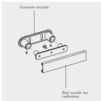
2 fixations positionnables entre les tubes et réglables pour un montage parfait.
