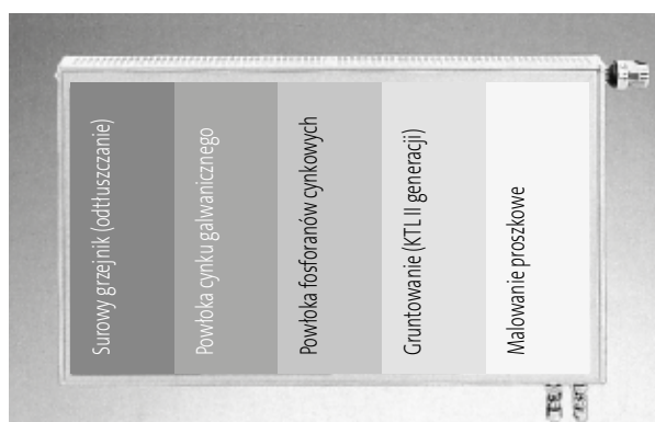
Przygotowanie powierzchni grzejnika
