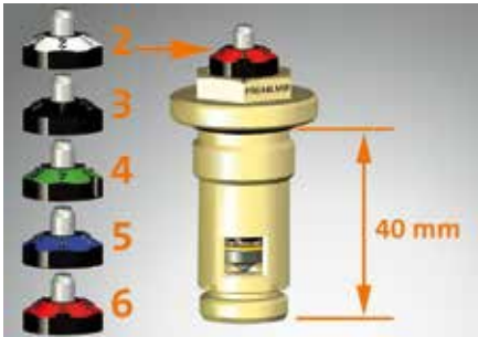
Purmo Ventilheizkörper werden seit 2011 sukzessive mit werkseitig voreingestellten Ventileinsätzen geliefert. Es gibt fünf verschiedene Ventile. Farbliche Markierungen zeigen an, mit welcher Voreinstellung das Ventil ausgeliefert wurde (Einstellwerte 2, 3, 4, 5 oder 6)
