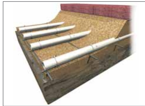
Напольное отопление на открытых пространствах
