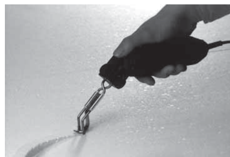
Rysunek 20 Elektryczny noż do wycinania kanalików
