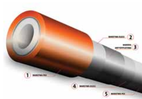
Rysunek 35 Struktura rury PexPenta
