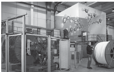
Rysunek 31 Bunkier w którym odbywa się proces sieciowania
