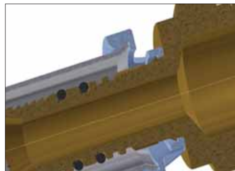
Rysunek. Przekrój korpusu złączki mosiężnej zaprasowywanej.
