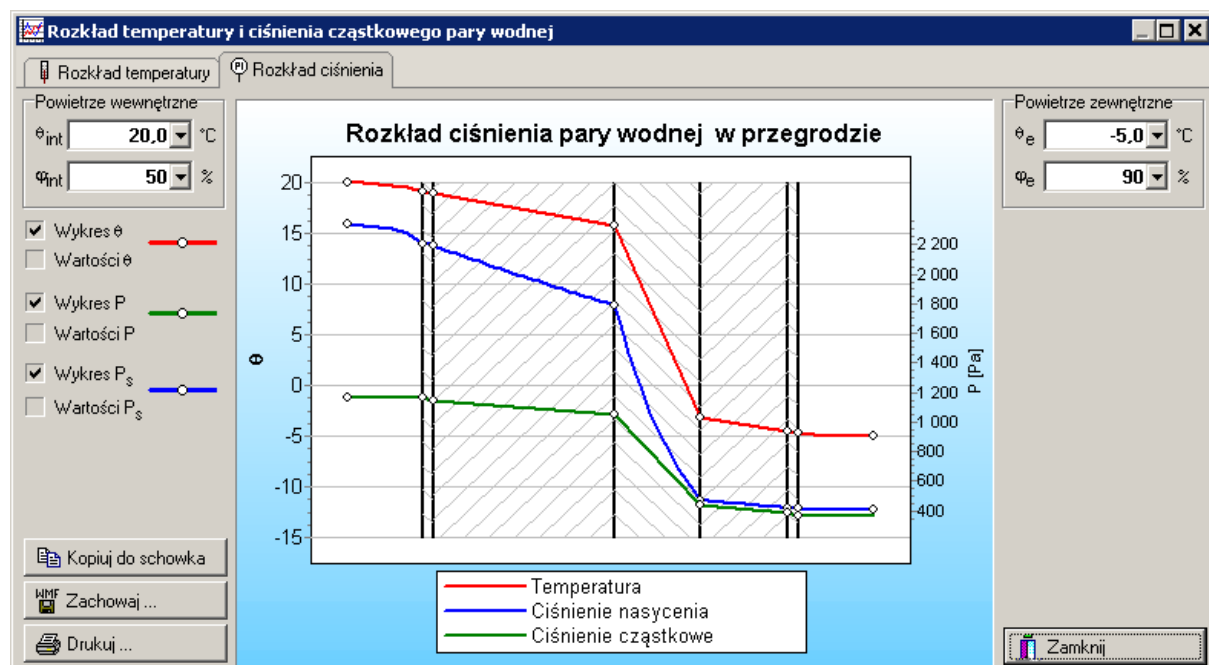
Rys. 10.8. Rozkład temperatury i ciśnienia cząstkowego pary w przekroju ściany zewnętrznej
