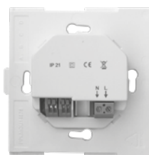
Abb. 104 Das UP-Anschlussmodul gehört zum Lieferumfang; der Anschluss an 230 V erfolgt über die Klemmen N und L
