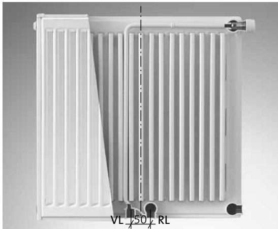
Abb. 30 Integrierte Ventilgarnitur für den Mittenanschluss. Schnitt und Funktionsmaße (in mm, VL=Vorlauf, RL=Rücklauf)
