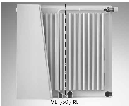
Abb. 60 Integrierte Ventilgarnitur für den Mittenanschluss. Schnitt und Funktionsmaße (in mm, VL=Vorlauf, RL=Rücklauf)
