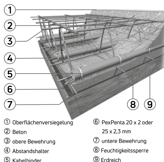
Abb. 90 Systemaufbau Industrieflächenheizung
