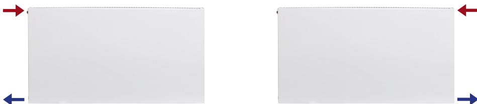
Päätykytkentä samassa päädyssä
