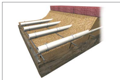
Напольное отопление на открытых пространствах
