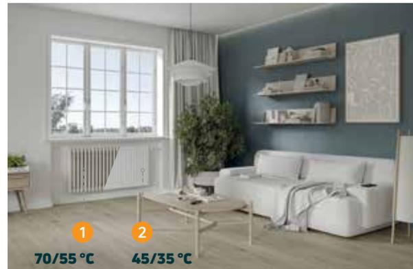
1 Vor der Renovierung: Der Heizkörper wird z. B. mit einer Vortauftemperatur von 70 °C betrieben.
