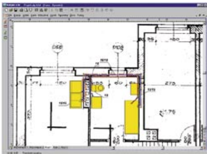
Rys. 4. Prezentacja wyników obliczeń na zeskanowanym rzucie kondygnacji
