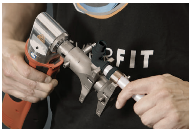
Tragerea inelului peste fitting
