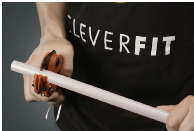
Tăierea corectă a conductei cu o foarfecă
