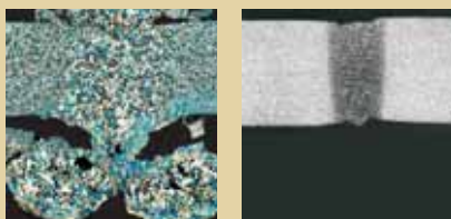
Spoina i resztki po spawaniu wewnątrz spawu konwencjonalnego grzejnika (po lewej) w porównaniu z precyzją laserowej spoiny w grzejniku DELTA (po prawej).
