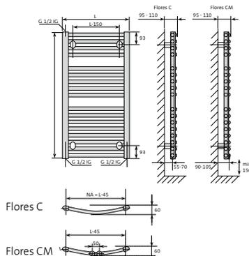
Dynamisch – Flores C (links) und Flores CM (rechts) mit markanten D-Profil-Sammelrohren und gebogenen Profilrohren
