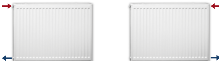
Päätykytkentä samassa päädyssä
