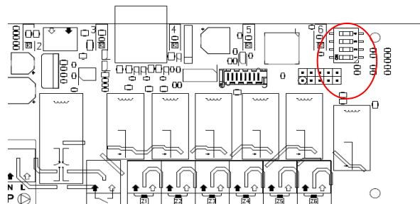
**Comutator 1: Configurare locala/generala a pompei (contact comanda pompa si dispozitiv de control de la distanta al pompei)**
